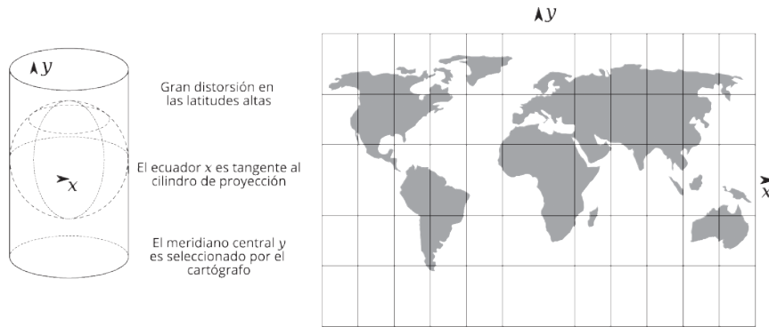
Figura 1. Explicación condensada de la proyección de Mercator
