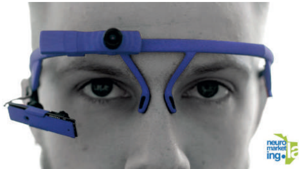
Figura 2. Eye tracker montado en la cabeza del participante
